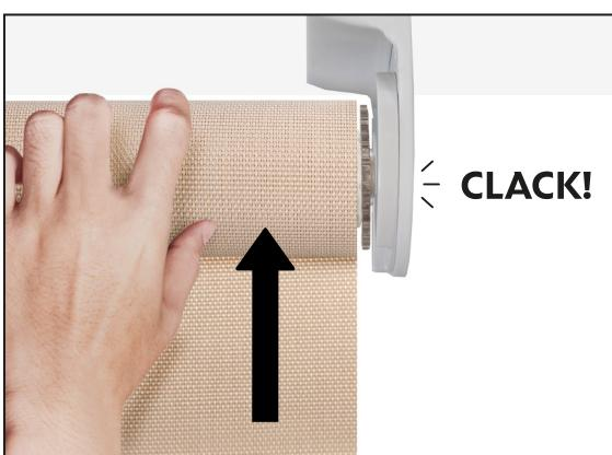
**5** Empujar el tubo de enrolle de la cortina hacia el centro del soporte usando la rampa hasta escuchar un **CLACK!**
